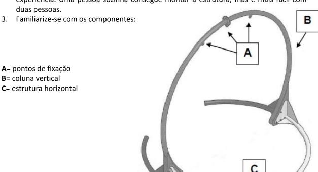
A estrutura consiste em 5 peças tubulares, 6 pés ajustáveis e conjunto de fixação.
