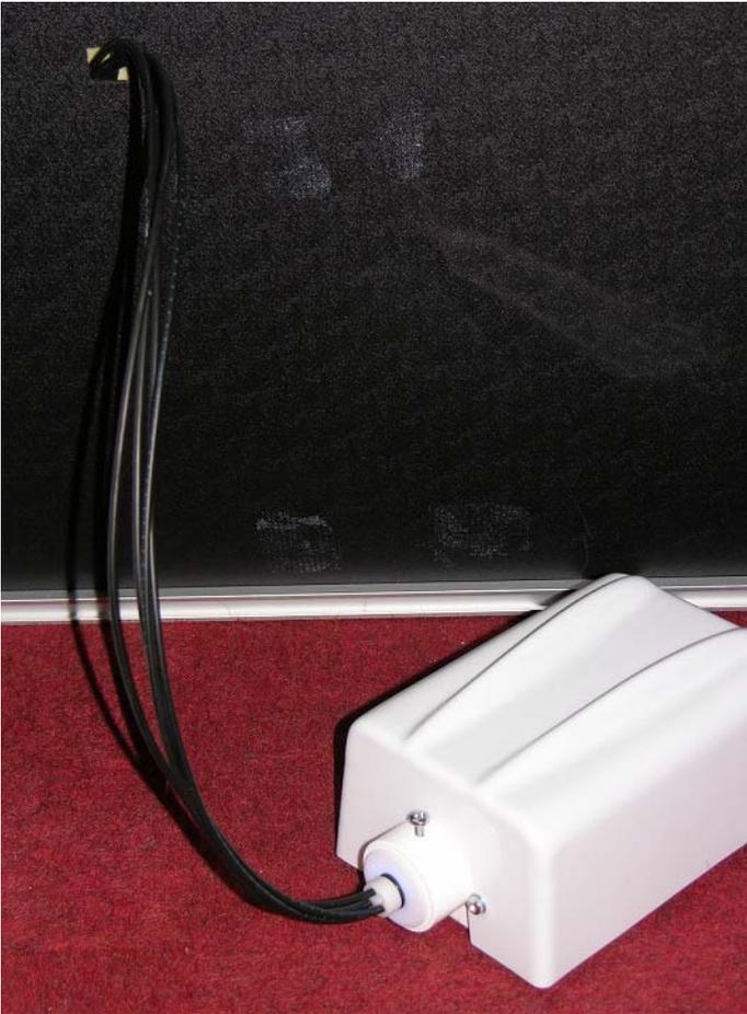
2. Ligue o cabo de alimentação na parte de trás da fonte de luz. Ligue na tomada e verifique se funciona. Tendo feito esta verificação volte a desligar. A luz só será visível de um dos lados. A face iluminada deve estar voltada para o chão.
